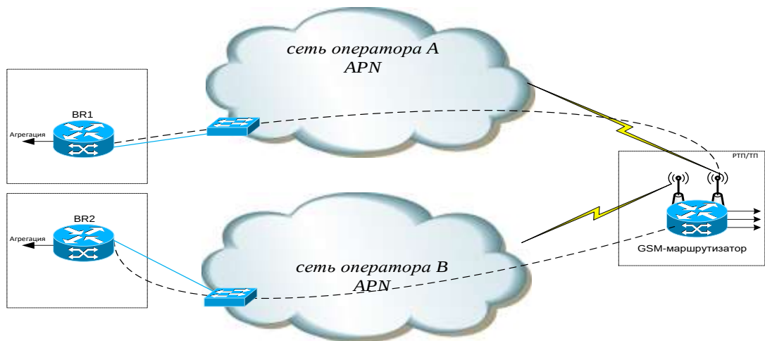
Рисунок 8. Участок беспроводной сети по APN
