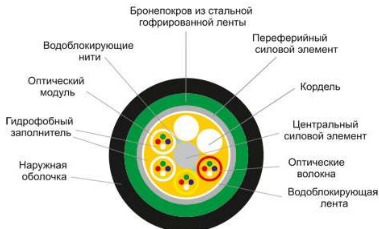
Рисунок 12. Пример конструкции ВОК для прокладки в зданиях
