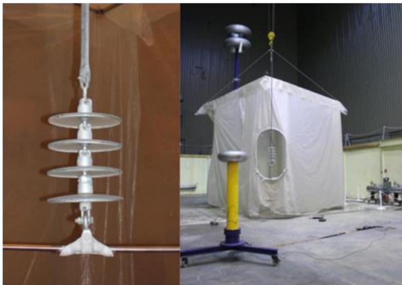
Внешний вид гирлянды изоляторов и испытательного оборудования
